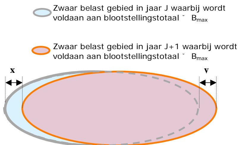
Figuur 2: Schematische weergave van tussen twee jaren verschillende ligging van een in beide jaren even groot gebied met zware geluidsbelasting.
