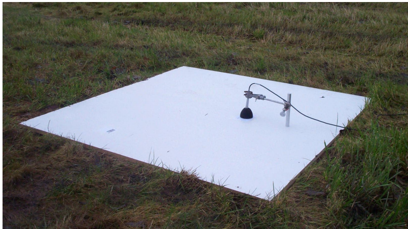
Figuur 2.2: Microfoon boven een harde plaat, met halve windbol.
