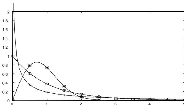
Figure 3-6: Weibull function for  $\eta=1$  and (+)  $\beta=1/2$ ; (o)  $\beta=1$ ; (\*)  $\beta=2$ .
